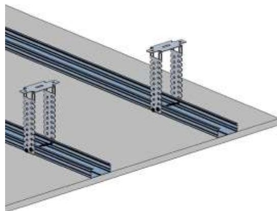
**MODE OPERATOIRE** : Disposer les suspentes U selon le DTU 25.41 avec une distance maximum de 1.2 m entre elles et respecter les charges admissibles
