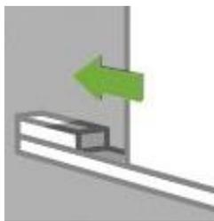
Insérez au marteau les clavettes à mi-longueur dans l'épaisseur du 1er panneau à raison de 3 clavettes pour 2,50 m de hauteur
